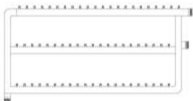
Colector en varios niveles
