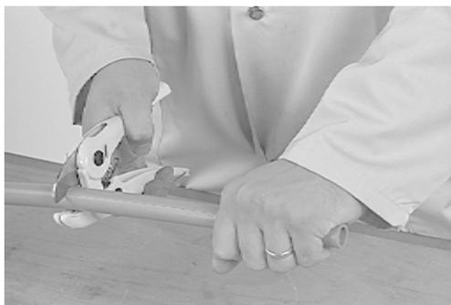
Cortes de tubería de 25mm y mayores
