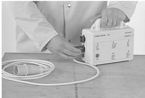
Conectar el cable de soldadura
